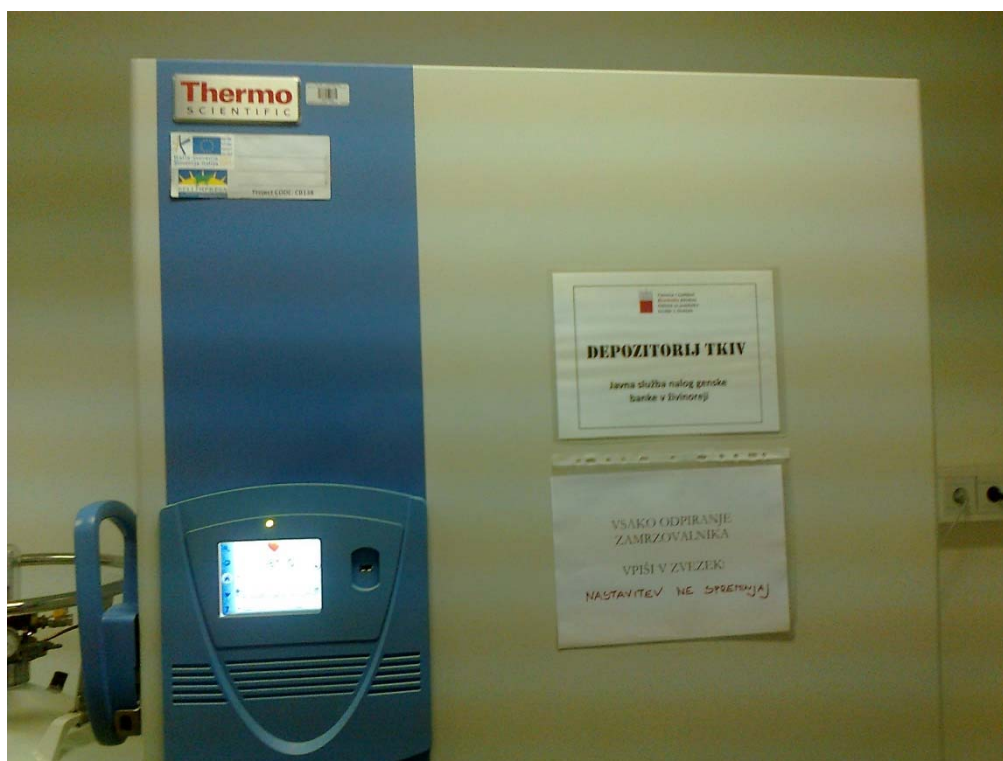
Slika 3: Označena zamrzovalna omara z monitorjem za spremljanje temperature
