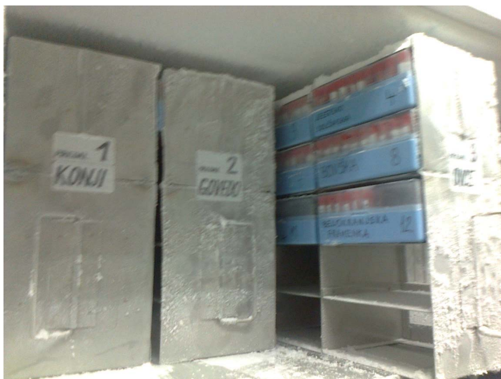
Slika 7: Vsak predal ima poličke za shranjevanje posebnih plastičnih škatlic odpornih na nizke temperature, kamor so postavljene krioviale z vzorci
